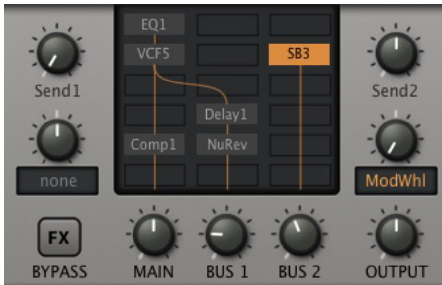
FX-Grid mit Beispiel-Routing
