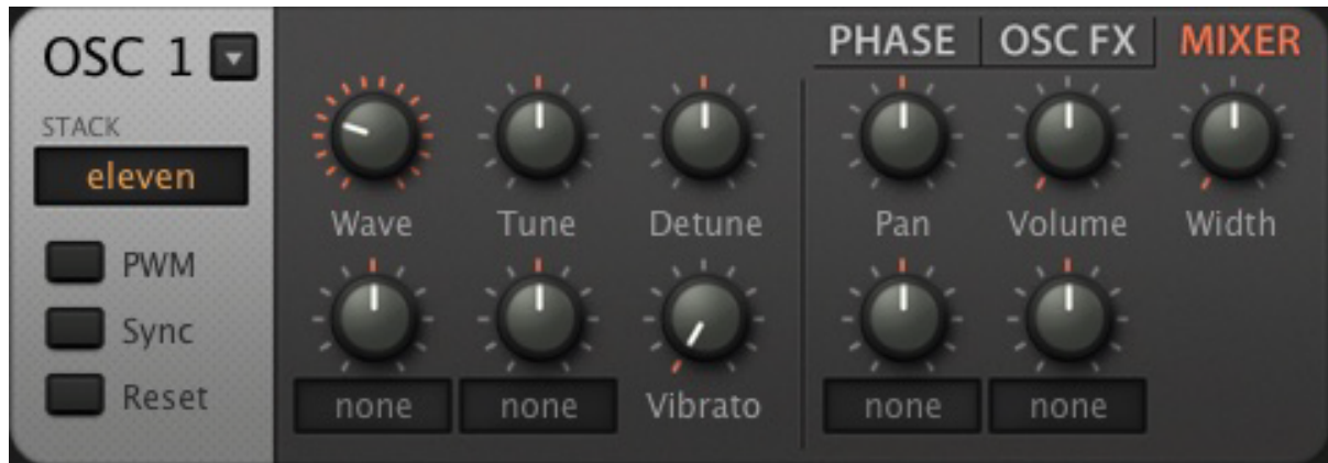
Oszillator-Fenster mit selektiertem MIXER Bereich
